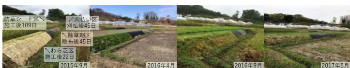
除草剤施用、防草シートおよびわら芝を導入した現地実証試験の様子(福島県川俣町の法面)
