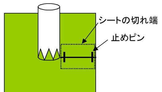
切り込み部が大きく空いてしまう場合にはシートの切れ端を下に差し込んでから止めピン固定してください。
