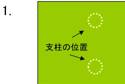
支柱がシートのどの部分にくるか確認し、チョーク等で印を付ける。
