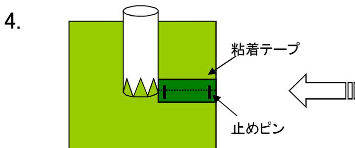
切り込み部分の端を止めピンで固定し、支柱までの切り込み部分に粘着テープを貼り付ける。
