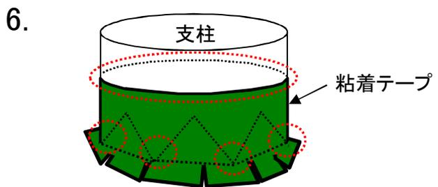
粘着テープをタコ足になるように折り曲げながらシートの切れ込み部分および円周上 $\odot$ に隙間ができないよう支柱周りに貼り付けていく。隙間があれば、追加で支柱周りを粘着テープを貼り付ける(1~2周)
